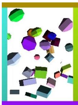
图 1 散粒体系统接触碰撞动力学模型
